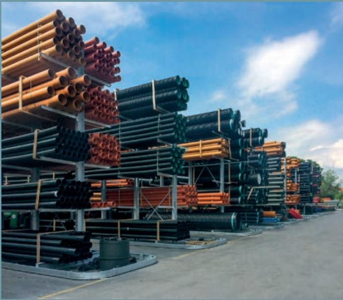
Aussenlagerung von Kunststoffrohren beim Großhandel. Feuerverzinkte Kragarmregale mit Führungsschienen für 4-Wege-Stapler.
