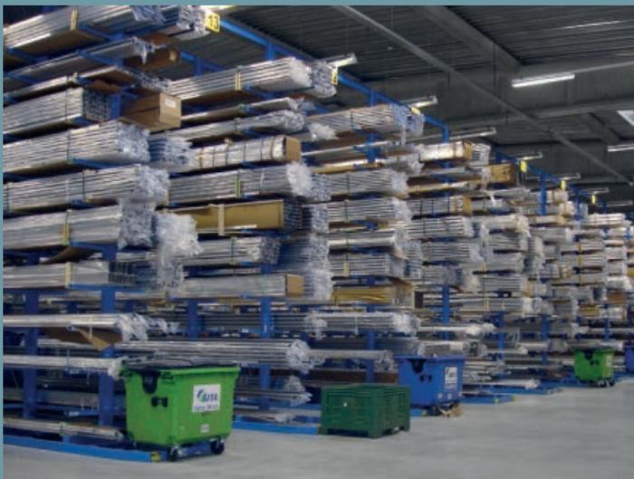
Schmalganganlage mit Gangbrücken für ein Aluminiumprofillager.
