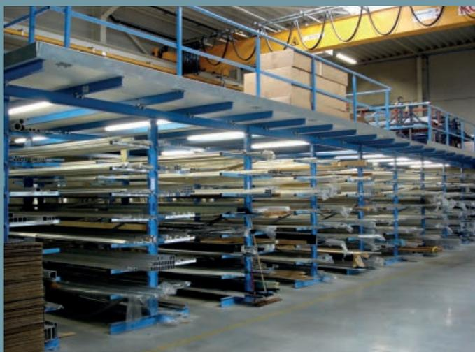
Kragarmregalanlage als tragende Konstruktion für integrierte Lagerbühne – zusätzlicher Platz und überschaubare Kosten.
