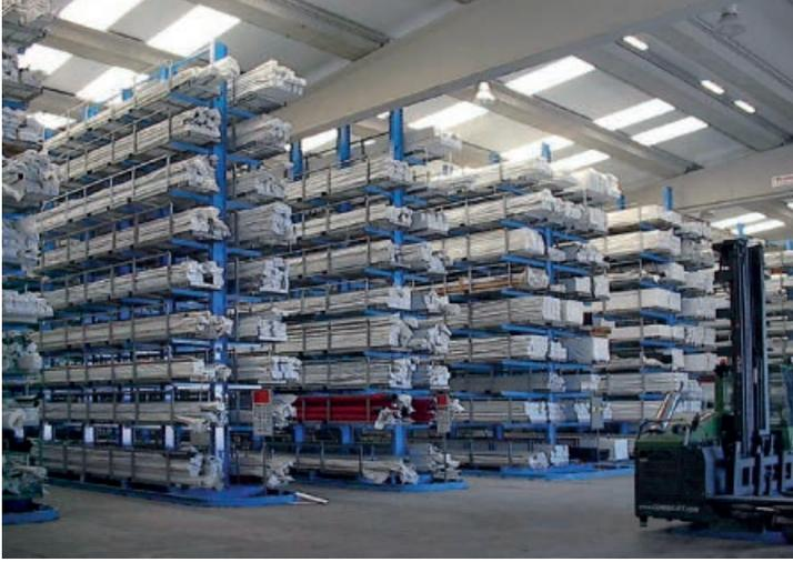
Schmalganganlage für die Lagerung von Kassetten – Bedienung durch 4-Wege-Stapler.
